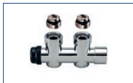
TO 101 Pièce H thermostatisable bitube pour alimentation au sol avec prérégulation avec embout femelle Double pipe H thermostatic valve for floor delivery with pre-regulation with female connection
