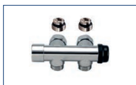
TO 104 Pièce H thermostatisable bitube pour alimentation murale avec prérégulation avec embout mâle Double pipe H thermostatic valve for wall delivery with pre-regulation with male connection
